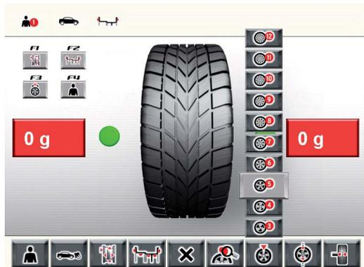
2. Установить требуемое положение (например, спицу) в положение на 12 часов.
