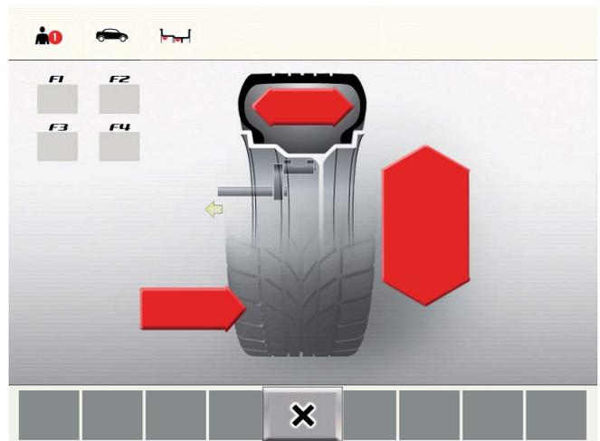
В программах балансировки Alu2, Alu3 (ALUDATA®) электронный измерительный кронштейн не обязательный. Обе точки измерения определяются с помощью раздвижного калибра.
