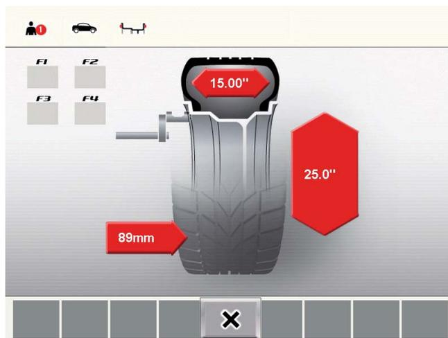
2. Считывание положения подтверждается звуковым сигналом, отображаются данные положения.
